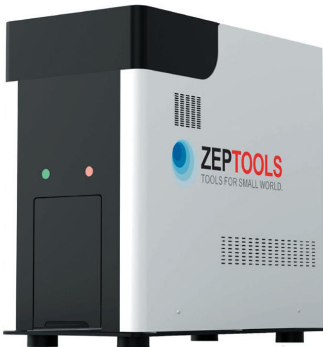
Настольный сканирующий электронный микроскоп ZEM 15 позволяет проводить анализ образцов с высоким увеличением и разрешением, а также осуществлять сбор данных об их элементном составе. Компактные размеры и эргономичный дизайн обеспечивают простоту использования, возможность установки СЭМ на обычный стол в любом помещении – как в офисе, так и на производстве. Источник электронов – вольфрамовая нить – позволяет пользователю проводить замену катода микроскопа.
